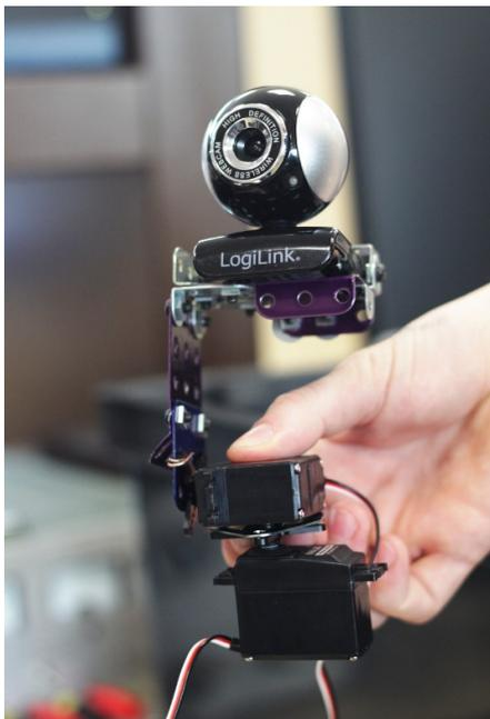
Nous avons fait le choix de construire notre bâti entièrement en mécano, non par nostalgie mais surtout car il s'agissait de la solution la plus simple et la plus rapide à mettre en œuvre !
